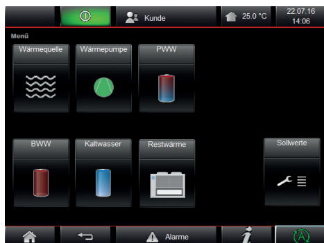
Betjeningsvenlig PLC-regulering med farve touch display
